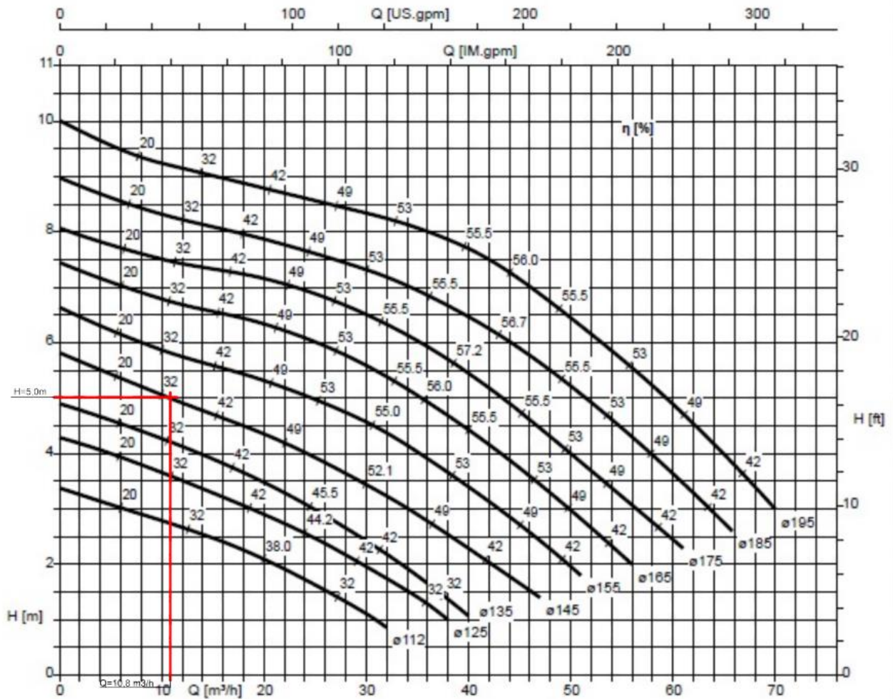
Rysunek 1. Pompy zatapialne do tłoczenia ścieków surowych z wolnym przełotem DN65 KSB NF 65-220 n=14650 \text{ min}^{-1} Q= 10,8 \text{ m}^3/\text{h} , wysokość podnoszenia 5,00 m, pobierana moc dla punktu znamionowego 1,5 kW.
